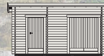
Galgat funkisbod 15 m 2 (4 750x3 150 mm) har ett golv på 25 mm för att klara extra tung belastning. Boden levereras med enkel- och dubbeldörr samt inner- vägg. Fönster finns som tillval.
