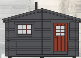
Bräska stuga/bastu 10 m 2 (4 055x3 850 mm varav stugdel 4 055x2 460 mm) har en glasdörr från Harvia mellan bastu- och relaxdel. Bastukaminpaket finns som tillval.
